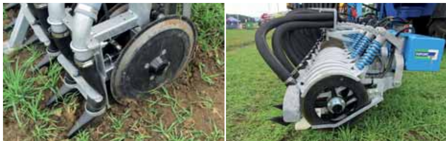
Obr. 19: Rýhovače pro tvorbu infiltrační rýhy pomocí disků nebo talířů (foto Brant).
