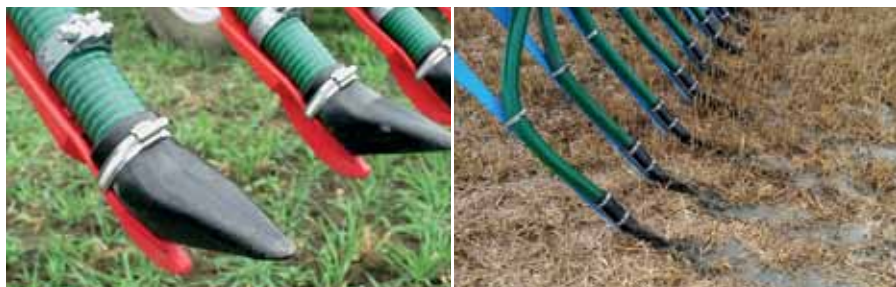
Obr. 17: Rýhovače umístěné přímo na aplikačních hadicích zakončených aplikační botkou (foto Brant).
