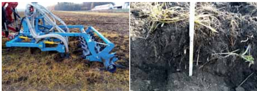
Obr. 42: Vliv aplikace kejdy na souběžné porušení ztuhlé vrstvy půdy (foto Brant).
