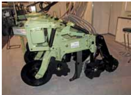
Obr. 24: Většina strojů pro aplikaci tekutých hnojiv vychází z koncepce aplikace hnojiva za kypřicí radlici (foto Brant).
