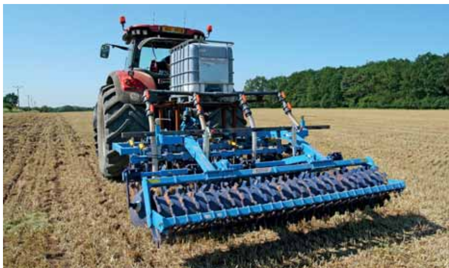
Obr. 47: Testovací stroj byl vybaven nádrží s roztokem obarvené vody (foto Brant).
