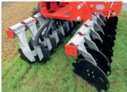
Obr. 21: Souběžné celoplošné mělké zapravení do půdy s hadicovým transportem ke kypřícím talířům (foto Brant).
