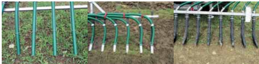
Obr. 15: Rozdílné způsoby zakončení hadicových aplikátorů pro povrchovou aplikaci tekutých hnojiv (foto Brant).
