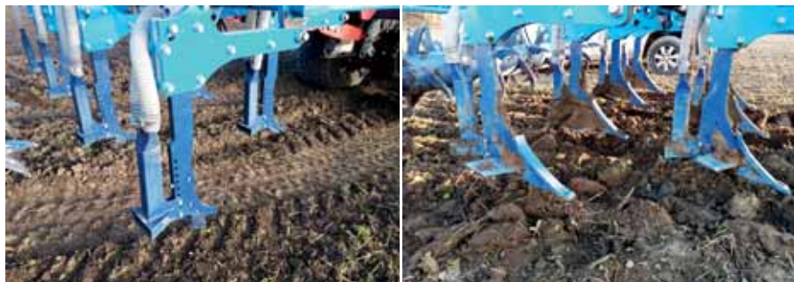
Obr. 43: Hodnoceny byly radlice se šířkou slupic 25 mm (vlevo) a 50 mm (vpravo) v kombinaci se širokými koncovkami (foto Brant).
