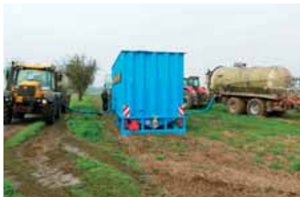
Obr. 12: Mezizásobníky tekutých hnojiv zvyšují nejen výkonnost pracovních linek, ale mohou přispět ke snížení počtu nepracovních jízd po pozemku (foto Farnet a.s.).
