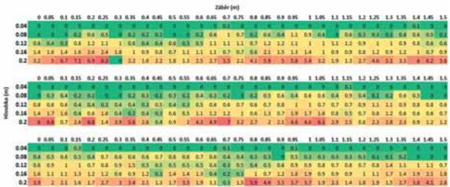
Obr. 68: Profil s vytvořenými infiltračními rýhami, profil s hodnotami penetračního odporu do hloubky 0,2 m s krokem měření 0,04 m.
