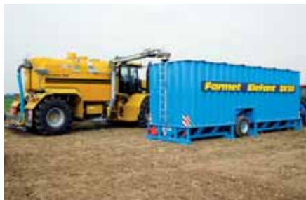
Obr. 12: Mezizásobníky tekutých hnojiv zvyšují nejen výkonnost pracovních linek, ale mohou přispět ke snížení počtu nepracovních jízd po pozemku (foto Farnet a.s.).
