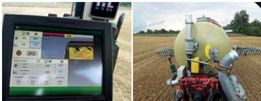
Obr. 27: Variabilní aplikace prasečí kejdy na základě aplikační mapy odběru dusíku (vlevo), vpravo je patrné umístění NIR senzoru na aplikační cisterně (foto Brant).
