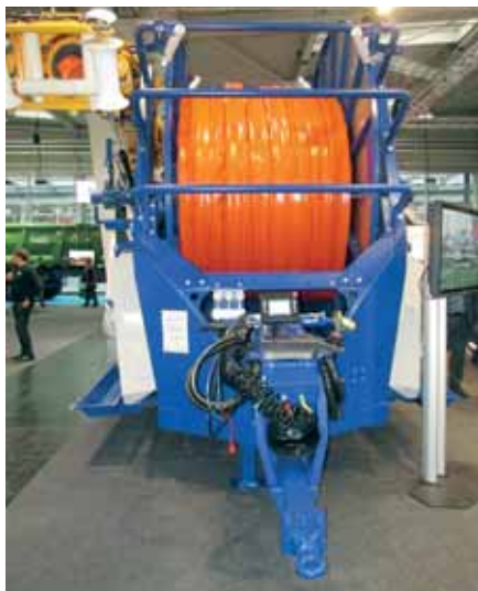
Obr. 6: Systémy vlečných transportních hadic lze využít u samohybných, tak tažených strojů (foto Brant).
