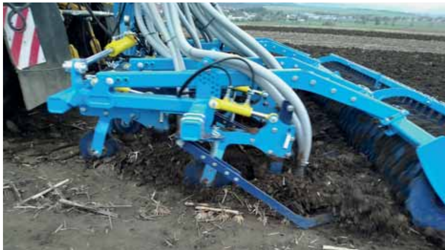
Obr. 58: Půda se před radlicemi rozevívá a za radlicemi se opět uzavívá, takže hnojivo je ihned zakryto, nešíří se zápach a jsou výrazně eliminovány emise \text{CO}_2 , \text{NH}_3 a \text{NO}_x (foto Farmet a.s.).
