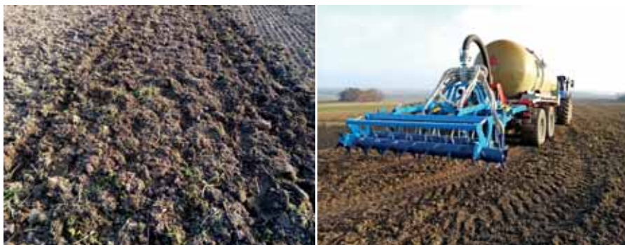
Obr. 45: Použití radlic s menší šíří slupic (25 a 50 mm ve srovnání se šířkou 75 mm) snížilo hřebenitost pozemku po provedení aplikace (foto Brant).
