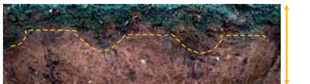
Obr. 63: Hodnocení infiltrace modré barvy na plochách s tvorbou infiltračních rýh.
