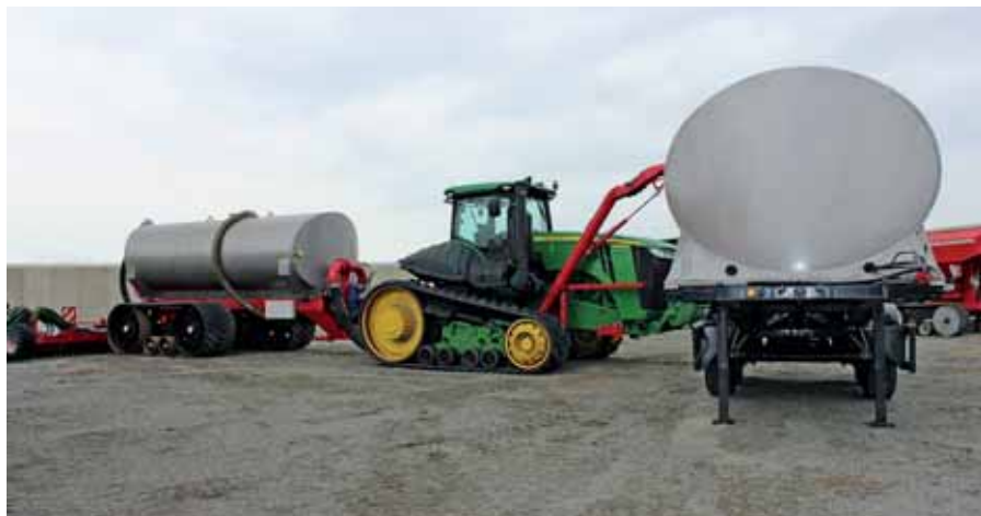
Obr. 5: Náhrada pneumatik u tažných prostředků a zásobníků tekutých hnojiv pásy (foto Kroulík).
