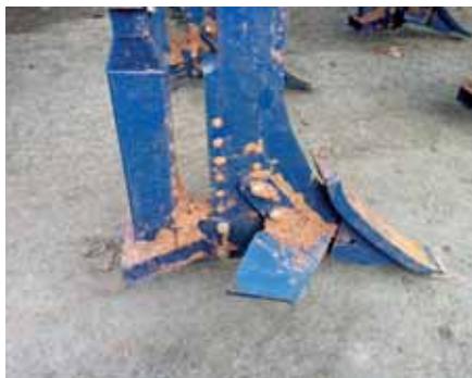
Obr. 40: Kypřící radlice s aplikátorem kapalných hnojiv s širokou koncovkou rozptylovače se šíří dláta 75 mm pro systém zapravení do proudu zeminy (foto Brant).
