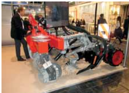
Obr. 25: Kypřiče s bočně zahnutou deskovou slupicí zakončenou dlátem (foto Brant).
