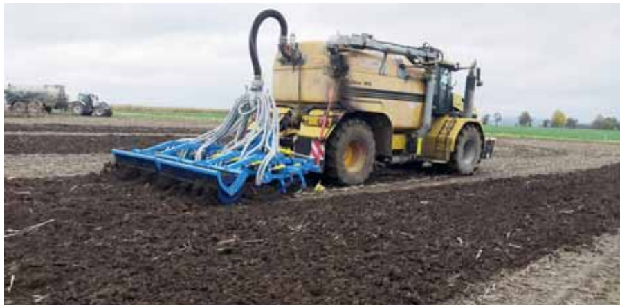
Obr. 56: Kromě výborného podpovrchového rozptýlení hnojiv nabízí nová řada aplikátorů také vysoce kvalitní zpracování půdy, a to i v podmínkách extrémního sucha nebo mokra (foto Farmet a.s.).
