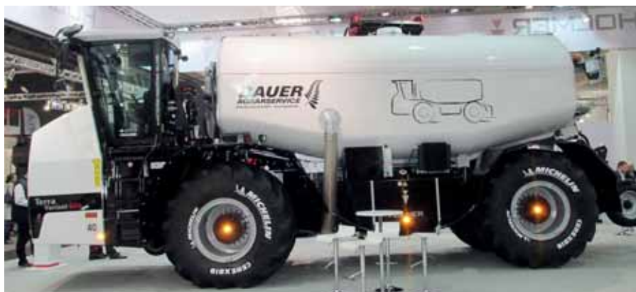
Obr. 4: Snižování tlaku v pneumatikách a využití krabího chodu je jednou z možností eliminace utužení půdy (foto Brant).
