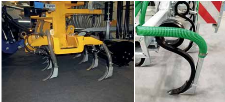
Obr. 22: Mělké či hlubší zapravení do půdy pomocí aplikačních dlát (foto Brant).
