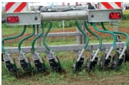
Obr. 20: Systémy otevření půdy pomocí šikmo postavených talířů (foto Brant).
