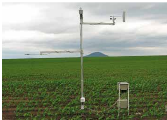
Stanovení hodnot aktuální (měřené) evapotranspirace v porostu kukuřice systémem BREB (výrobce EMS Brno)
