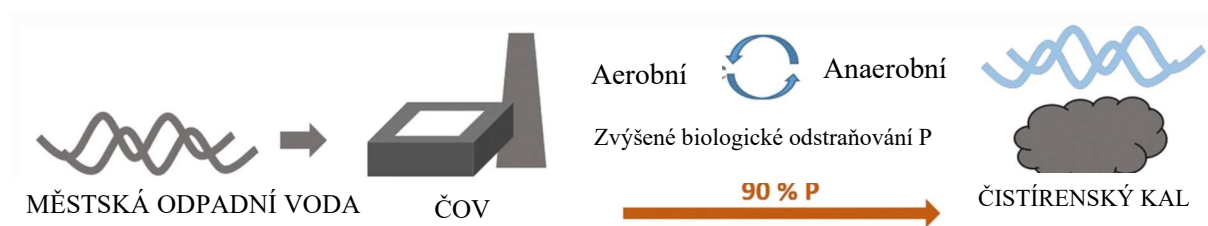
Obrázek 4 - Proces tvorby čistírenských kalů v čistíreně odpadních vod (Meng et al. 2019).
